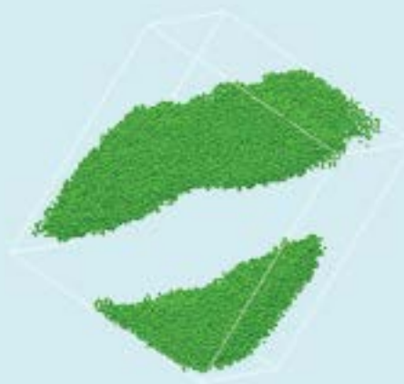
Рис 5. Плурионировый полимером с водоотталкивающими сегментами. Система состоит из 125 000 частиц, в кубическом объеме с ребром 23 нм. Моделирование проводилось в течение 3 мс.
